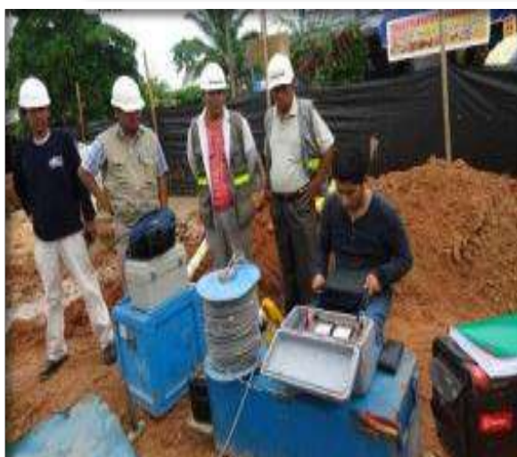
Registro de diagraya (resistividad y rayos gamma)
