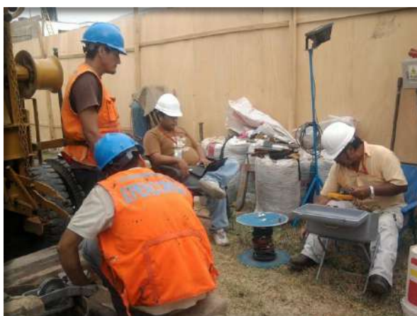
Registro de diágrafa (resistividad y rayos gamma)
