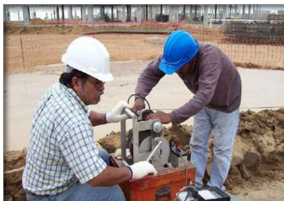
Registro de diágrafa (resistividad y rayos gamma)
