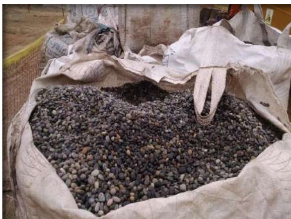
Grava seleccionada que se usara como pre filtro
