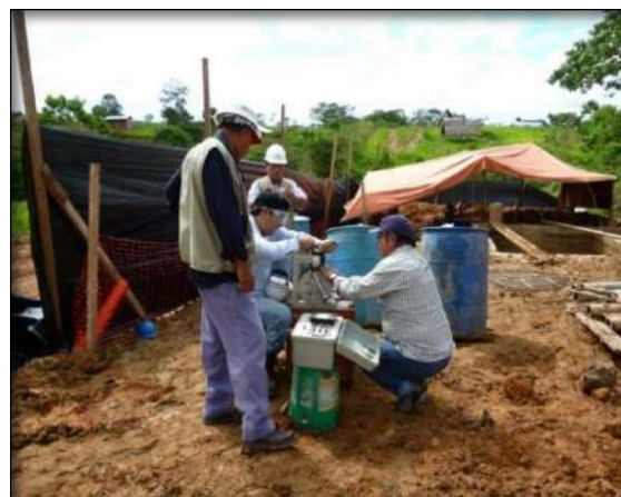
Reaistro de diaarafia (resistividad y rayos aamma)
