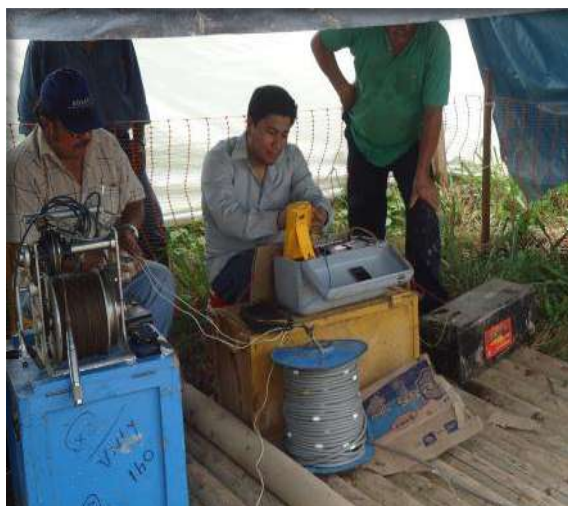
Registro de digrafía (resistividad y rayos gamma) tubular
